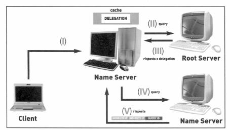
Figura 2 - Schema del processo di risoluzione dei domini Internet su cui si basa il funzionamento dei DNS
